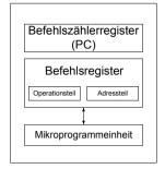
Mit Hilfe dieser Komponenten ist das Steuerwerk für das Laden der Befehlen aus dem Speicher, Decodieren und Interpretieren der Befehle und für die Steuerung der Bauteile verantwortlich.
